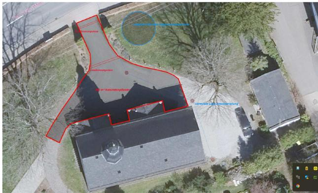
Pflasterung des Vorplatzes mit Granitpflaster von der Ostseite der Kirche bis zur Anbindung an den bereits vorhandenen Weg zur Trauerhalle. Dabei muss Oberflächenwasser aufgenommen und abgeleitet werden. Die Fläche umfasst etwa 200 m<sup>2</sup>.
